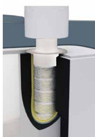
Eksos slange, isolasjon, taggjennomføring og pipehatt.
