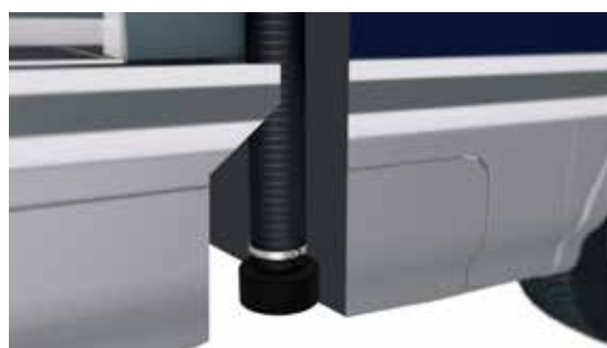
Innlufts slange og innlufts flens
